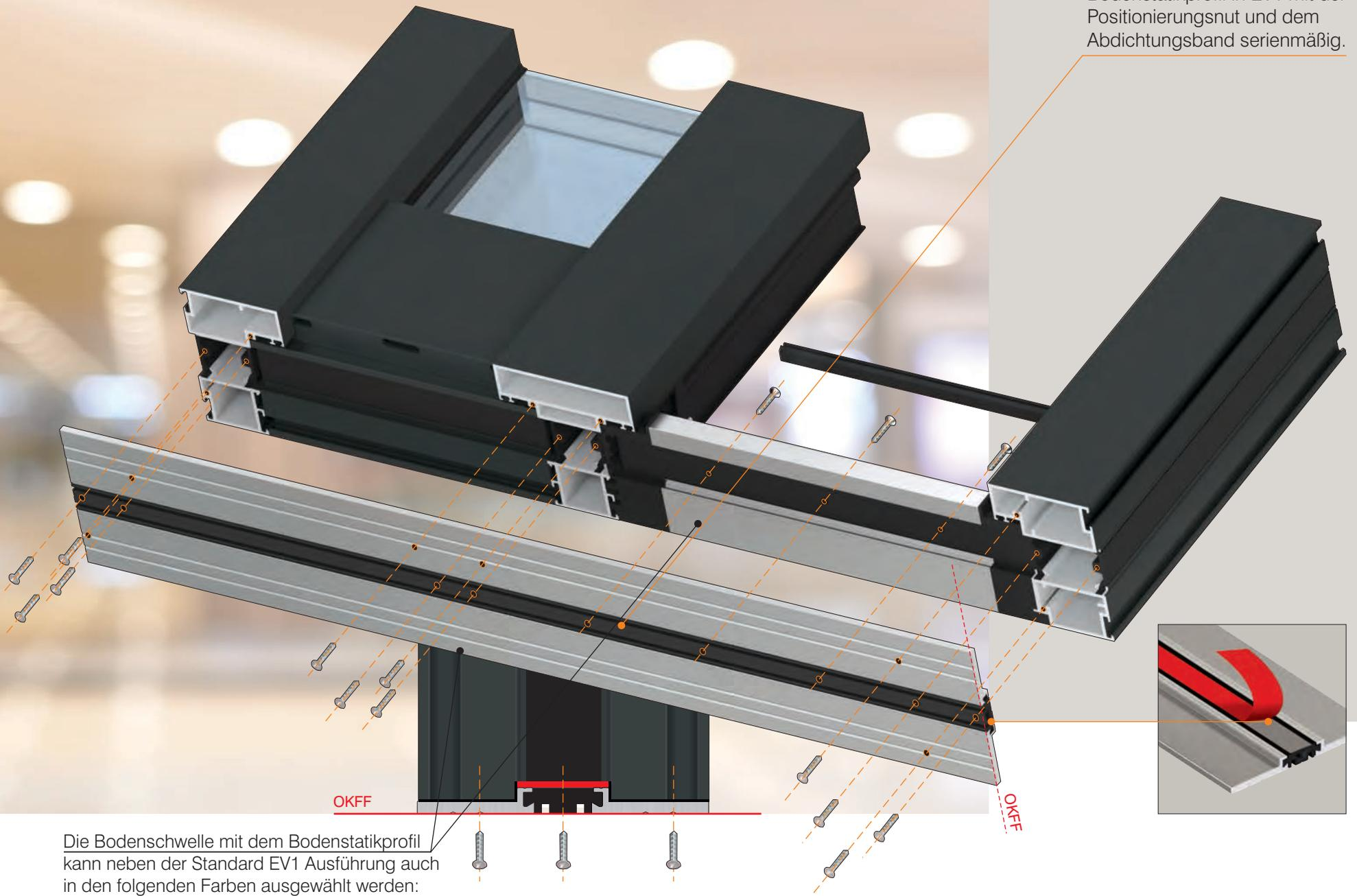
Die Bodenschwelle mit dem Bodenstatikprofil kann neben der Standard EV1 Ausführung auch in den folgenden Farben ausgewählt werden:
